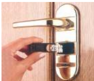
Abrir a embalagem que contém o novo bloco MIA, retirar o segredo que se encontra na fechadura, com a ajuda do extractor que acompanha a embalagem
